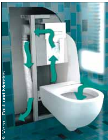
„Naserümpfen“ ist passé mit einer solchen Absaug-Technik. Ein integrierter Radiallüfter saugt Gerüche dort ab, wo sie entstehen (links). Ein WC mit Knöpfchen ist ideal für jung und alt. Die Anpassung um bis zu acht Zentimeter erfolgt stufenlos (mitte). Dieses randlose WC kommt ohne den üblicherweise umlaufenden, verdeckten Spülrand im WC-Becken aus, in dem sich leicht Verschmutzungen und Keime sammeln können.
